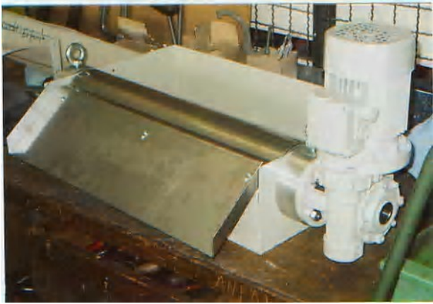
Fotografie eines VMA 600 mit demontierter Gummidruckwalze in der Montageabteilung
